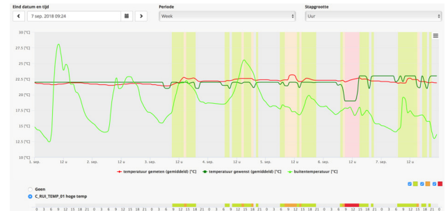
Voorbeeld controle ruimtetemperatuur tijdens bedrijfstijd
